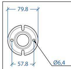
Bei allen parallel zur Wand befestigten Griffen: Abstand Wand bis Mitte Rohr 88 mm, ausgenommen E-Serie 70 mm.
